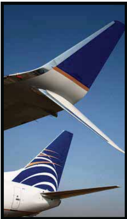
Los Split Scimitar Winglets reducen la resistencia aerodinámica.
